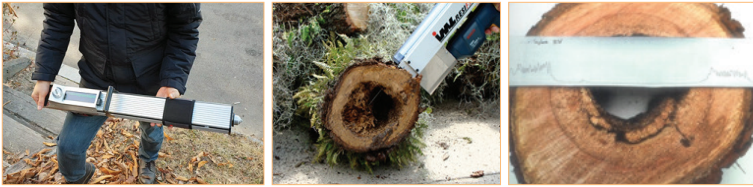
〈그림 13〉 저항기록드릴(resistance-recording drills)과 고해상도 저항드릴 프로파일 (Dunster, J. A. 2013.)
